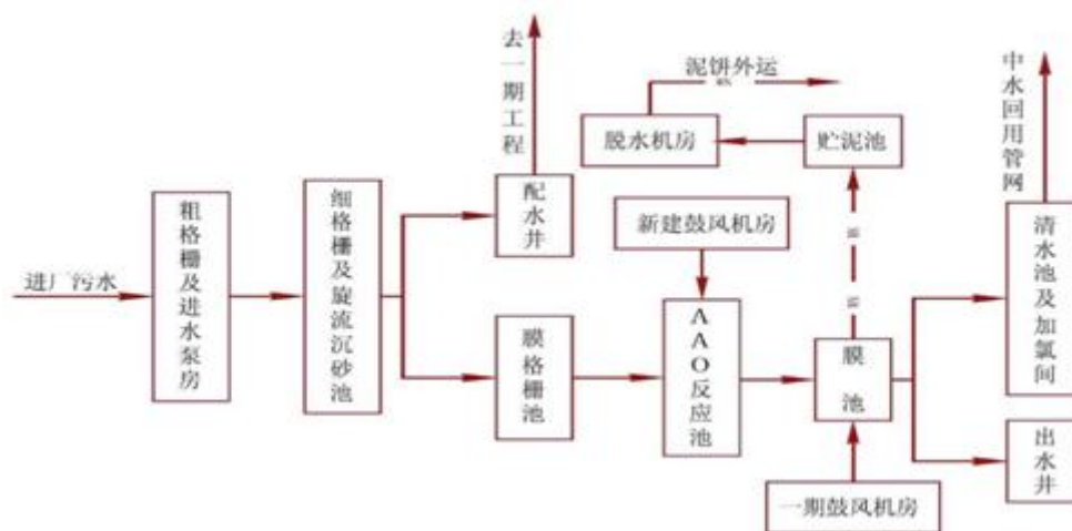
图 4-4 污水处理厂二期废水处理工艺流程简图
